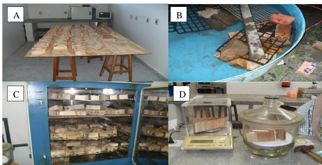
Figura 12: Sequência de etapas para determinação da densidade da madeira.
