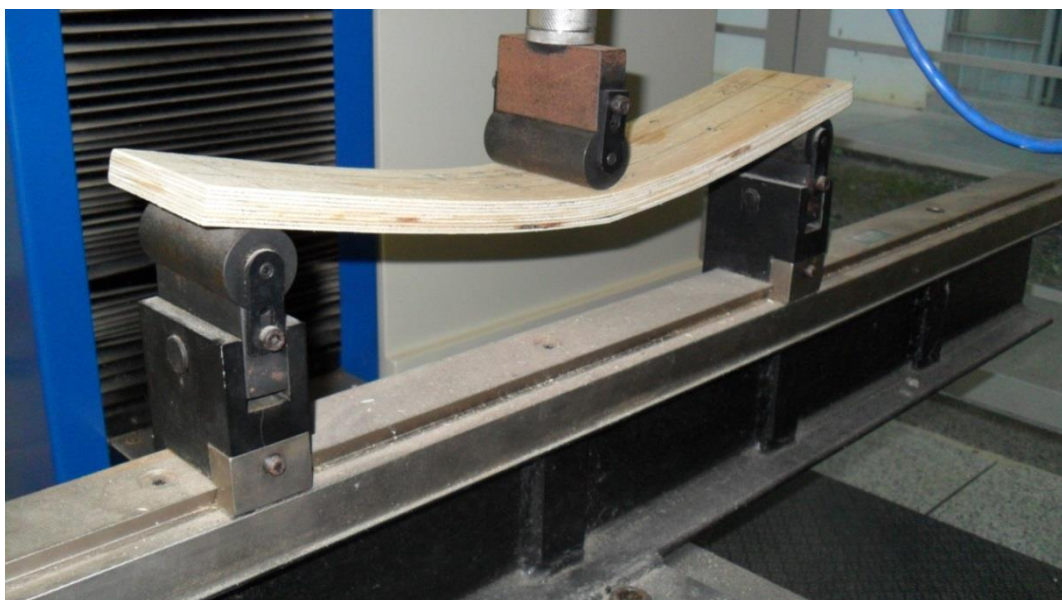
Figura 20: Corpo de prova sendo submetido a um ensaio de flexão estática.
