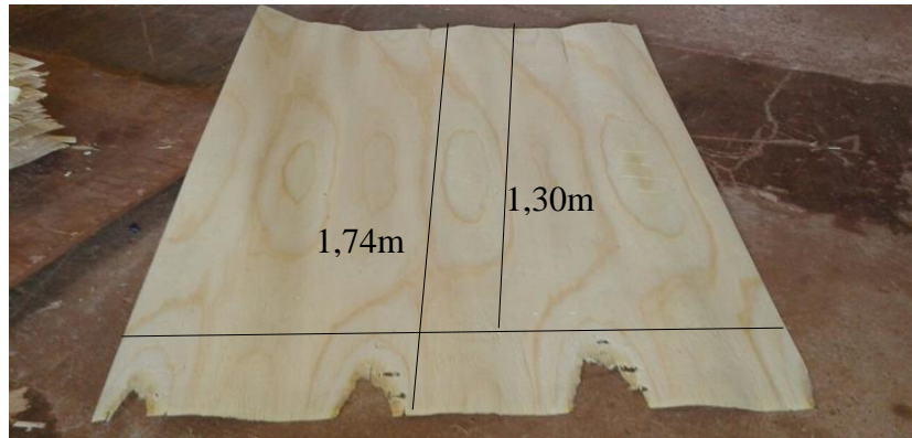
Figura 14: Lâmina de 1,30 m aproveitamento de 1,74m devido à retirada dos defeitos. Fonte: Autor (2016).
