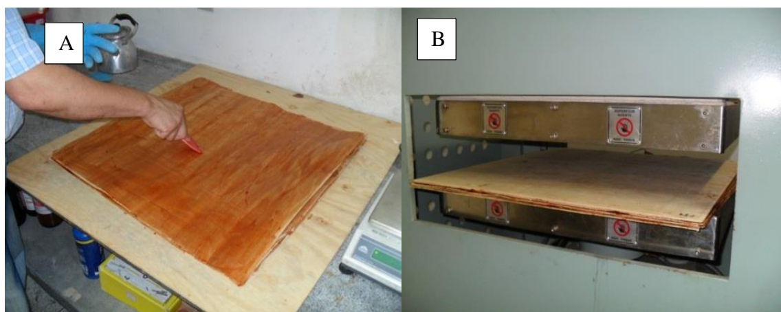
Figura 17: Etapas de aplicação da cola e prensagem dos painéis.
