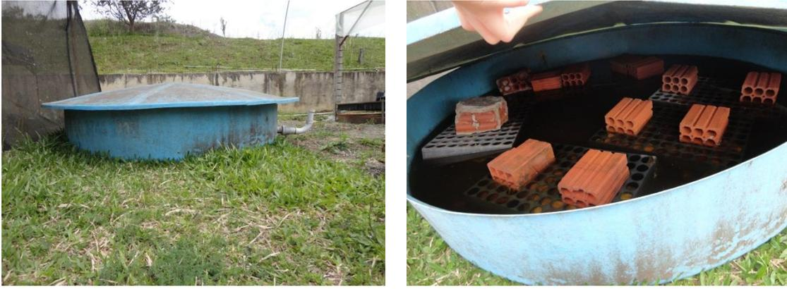
Figura 3 - Tanque para saturação de corpos-de-prova.
