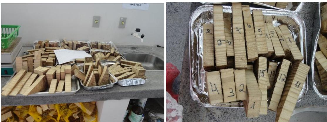
Figura 6 - Corpos-de-prova completamente secos, recém-retirados da estufa.
