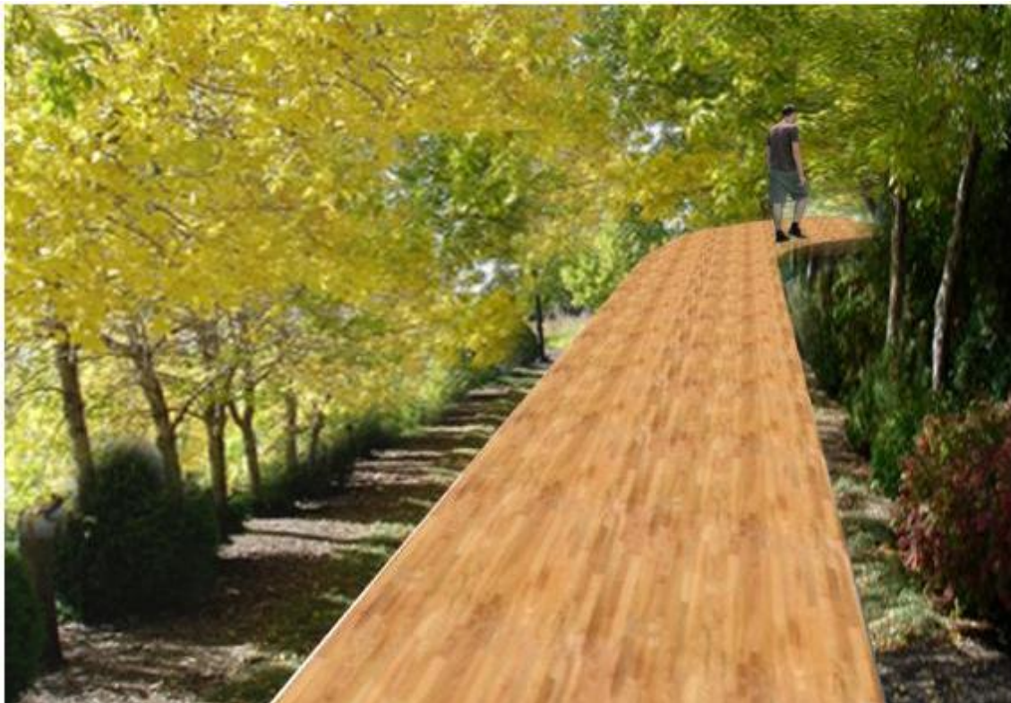
Passeio elevado acessível e com corrimãos localizados em partes estratégicas e que necessitam do mesmo. Sua largura é de 2 metros e seu revestimento é de madeira bio sintética em todos os trechos, promovendo uma melhor locomoção.
