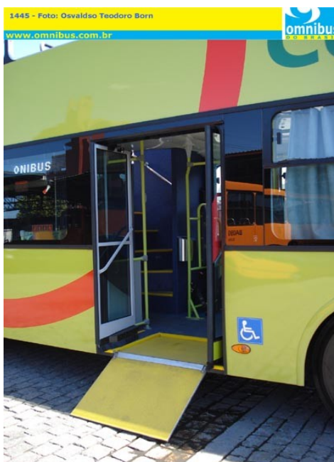
Figura 8 – Rampa de auxílio à entrada de portadores de cadeira de rodas. Fonte: http://oscadeirantes.blogspot.com.br/2011/01/curitiba-ganha-novos-onibus-para-linha.html
